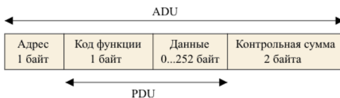
Рис.3. Формат кадра протокола Modbus RTU . PDU - "Protocol Data Unit" - "элемент данных протокола"; ADU - "Application Data Unit" - "элемент данных приложения"
